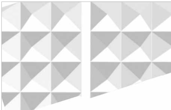
Absorber mit einer Fuge von min. 20 mm verkleben
